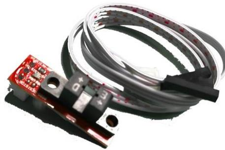
*Figura 16. Sensor final de carrera óptico soldado a placa de circuito impreso*
