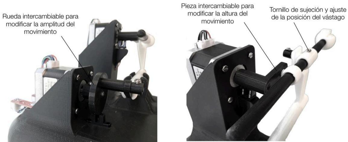
*Figura 37. Fotografía del detalle de los mecanismos del dispositivo en el que se indican las diferentes opciones que permiten parametrizar el movimiento*
