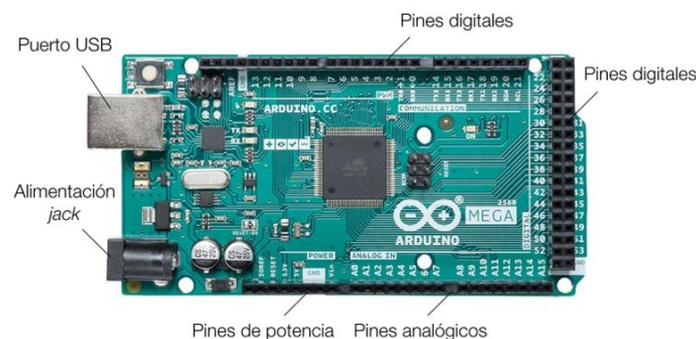
Figura 12. Placa Arduino Mega 2560 REV3 (Arduino, 2018)
