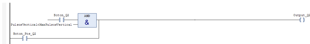
Ilustración 61. Ejemplo de programación en diagrama de contactos (LD) en SoMachine
