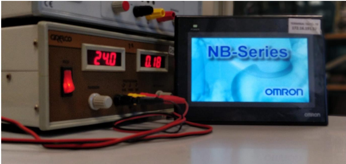
Ilustración 72. Alimentación de la pantalla táctil Omron
