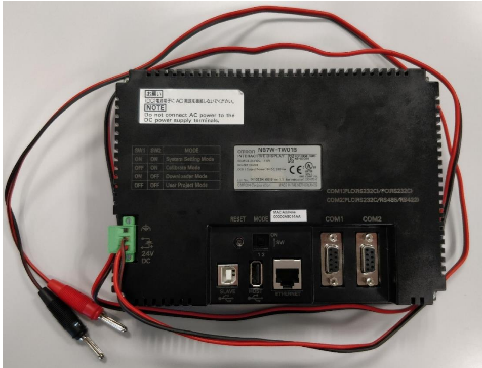
Ilustración 73. Parte posterior de la pantalla táctil Omron
