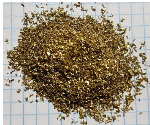
Imagen 5: Viruta generada en el corte.
