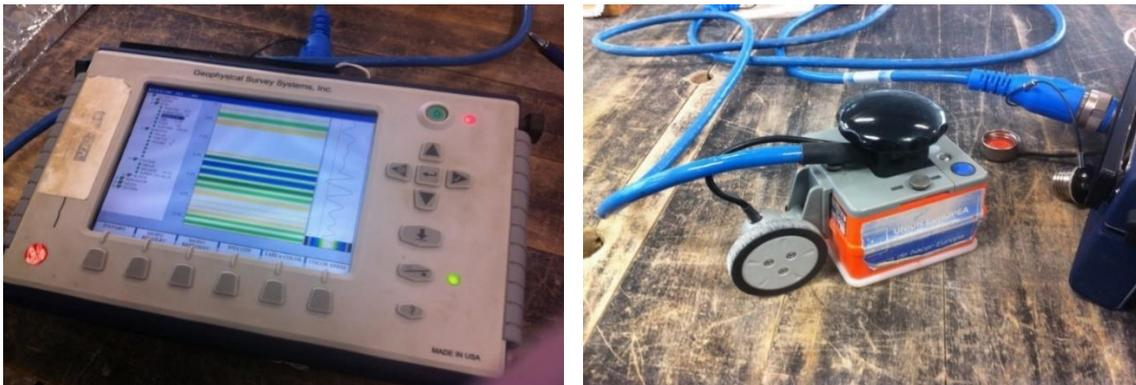
Figura 6.13. Equipo de georadar modelo SIR-3000 y antena de 2 GHz montada con odómetro de GSSI.
