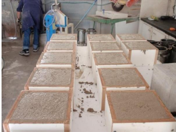
*Figura 6.11. Curado del hormigón.*
