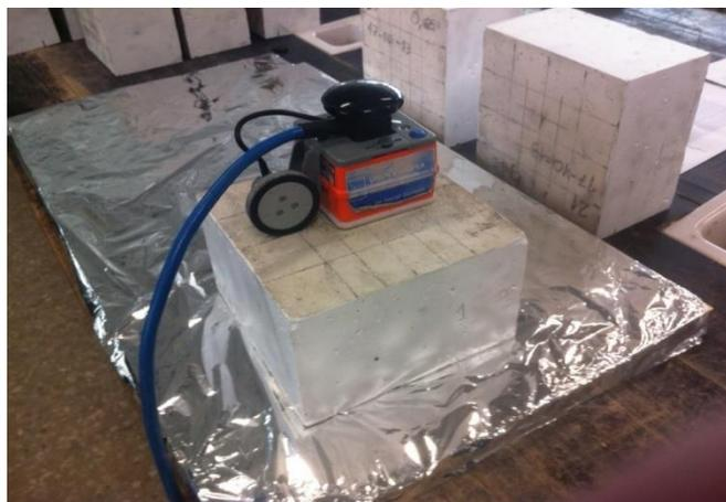
Figura 6.14. Dispositivo de la adquisición de registros de georadar.
