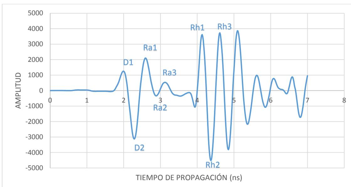
Figura 7.27. Señal registrada cuando el hormigón fabricado se encontraba completamente seco en el horno.
