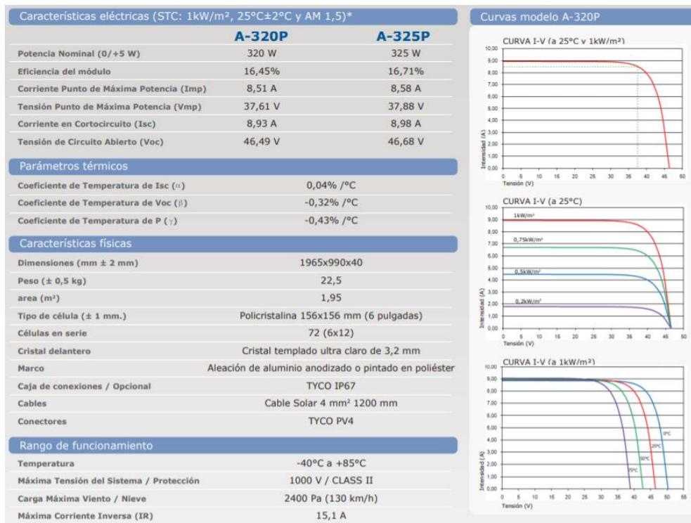
Figura 4. Características del módulo fotovoltaico. Fuente: Atersa.es
