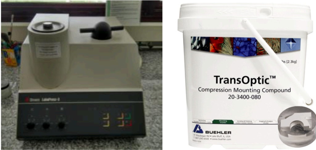
Ilustración 28. Máquina de embutición y compuesto termoendurecible
