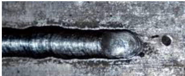
Ilustración 15. Cráteres en el cordón de soldadura
