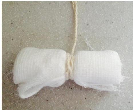
**Figura 10.** “Hisopo de Moore” utilizado para la toma de muestra de *H. pylori* en agua potable.
