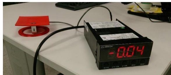
Figura 10: Sensor utilizado para medir la fuerza aplicada por la sonda en las mediciones de la permitividad relativa
