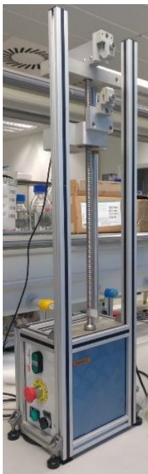
Figura 15: Máquina electromecánica microtest
