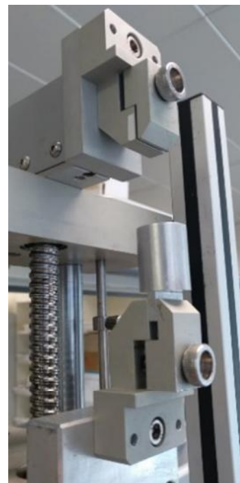
Figura 17: Detalle mordazas y recipiente para las muestras
