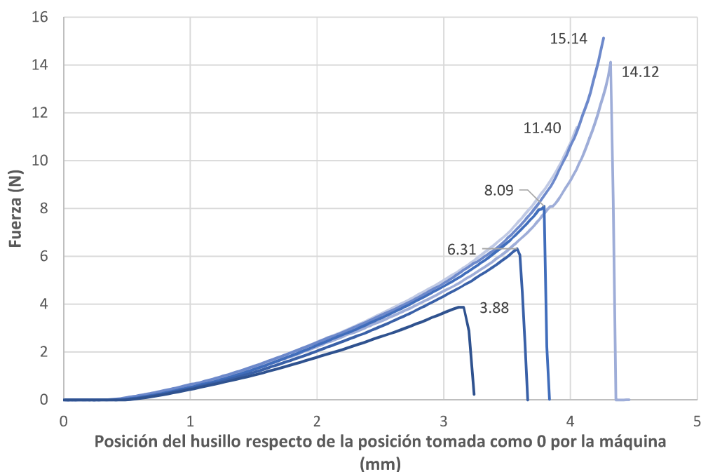
Figura 26: Ensayo completo de fuerza de rotura para las distintas réplicas de hidrogel PHEA con 0.2% de entrecruzador y sumergido en agua
