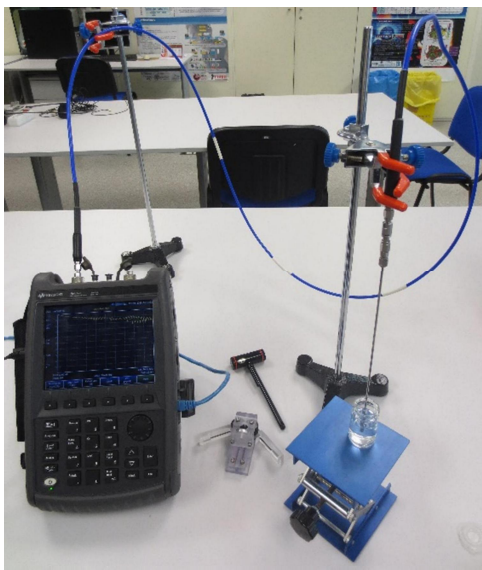
Figura 9: Analizador de redes vectoriales empleado para las mediciones de la permitividad relativa
