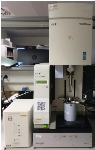
Figura 12: Dilatómetro Seiko TMA.
