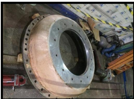
Figura 14 Tapa de turbina desmontada.
