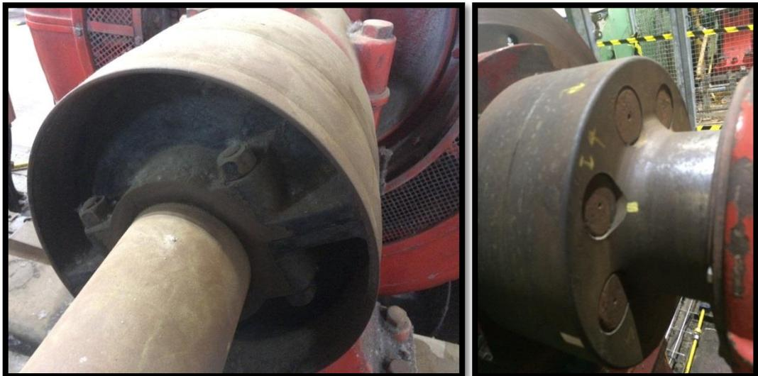
Figura 15 A la izquierda la protección de la unión de los ejes y a la derecha la unión de los ejes turbina-alternador.
