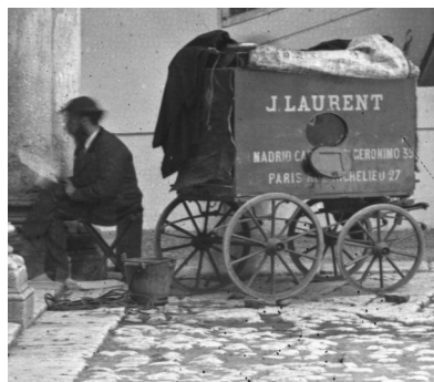
12. Laboratorio portátil utilizado en la toma de fotografías mediante la técnica de vidrio al colodión
