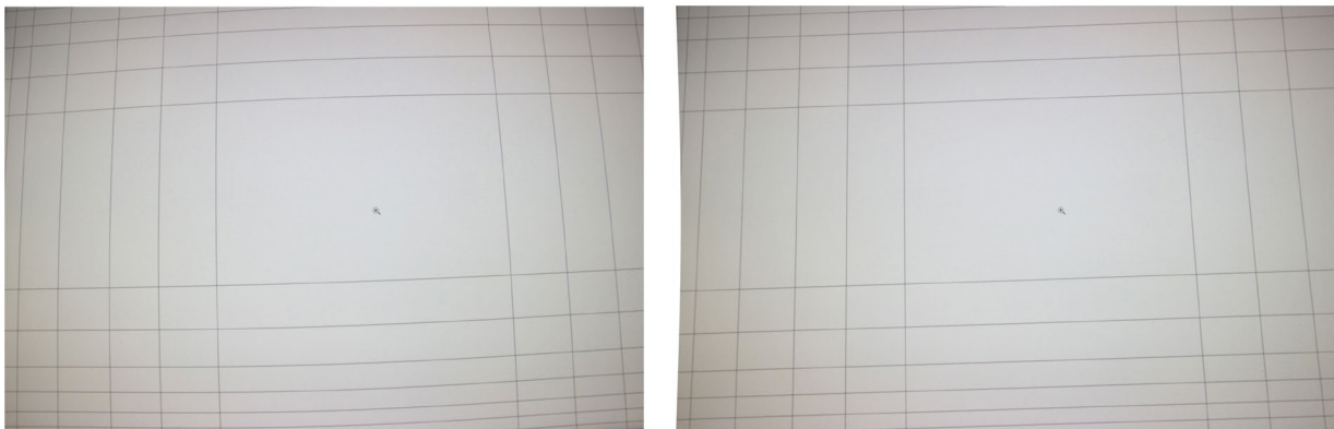
20. A la izquierda se muestra la fotografía original, donde se aprecia la distorsión radial. A la derecha, la fotografía corregida mediante Hugin.
