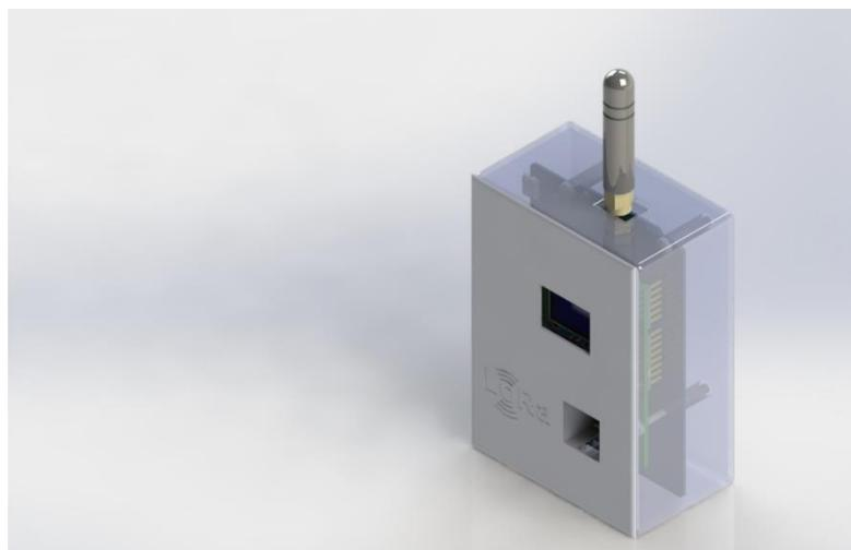
Figura 86 - Renderizado 3D del nodo sensor montado en la carcasa
