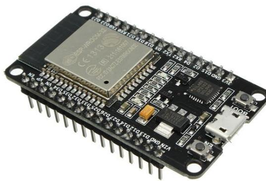
Figura 30 - Tarjeta de desarrollo con el módulo ESP-WROOM-32
