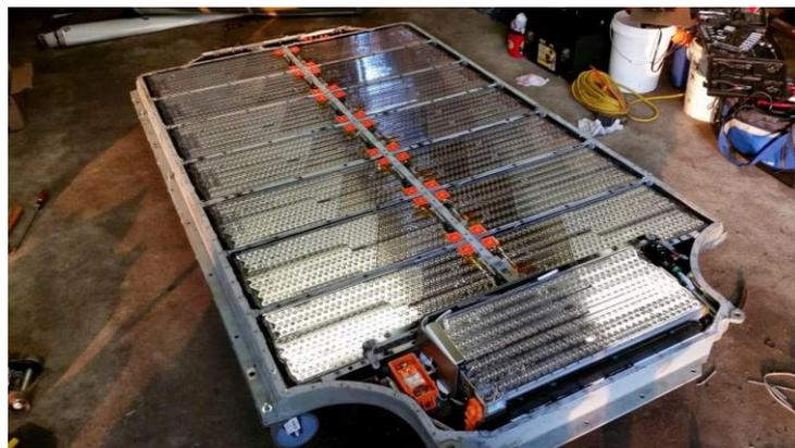
Figura 40 - Pack de baterías de un vehículo Tesla Model S
