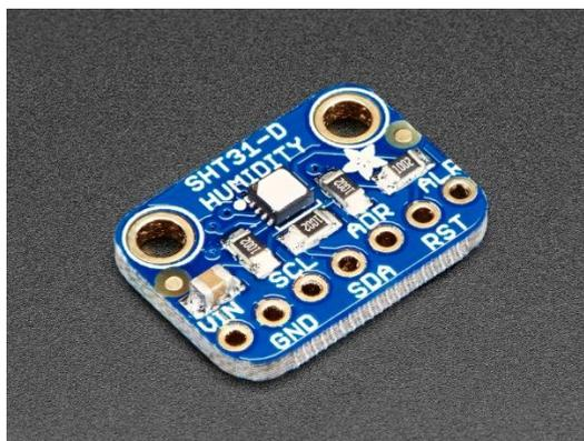
*Figura 3 - SHT31 montado en placa de evaluación de Adafruit*
