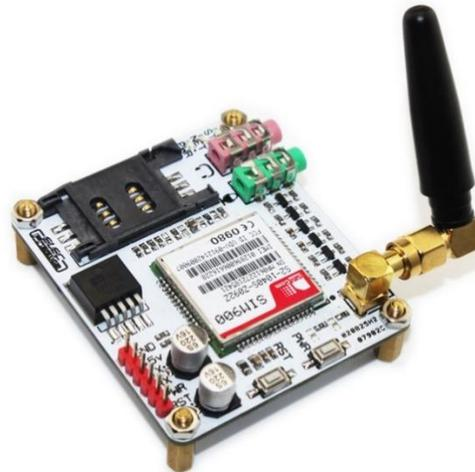
Figura 17 - Módulo GSM con slot para tarjeta SIM
