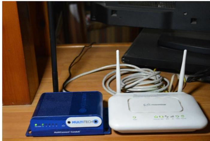
*Figura 76 - MultiConnect Conduit instalado y conectado al router*
