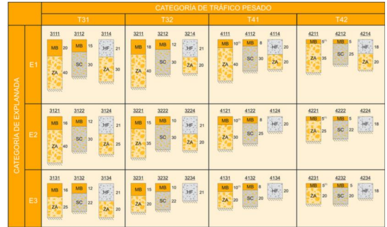
Figura 46. Catálogo de secciones de firme (Fuente: Norma 6.1-IC)
