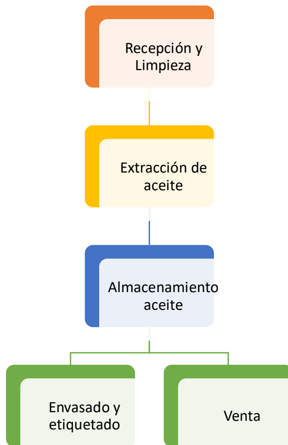
Esquema 2. Acciones en la industria de extracción de aceite
