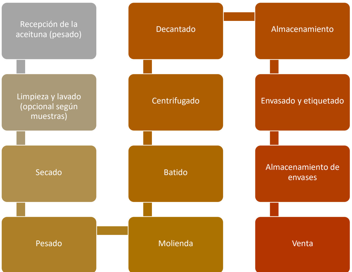
Esquema 3. Diagrama de flujo para la obtención del aceite de oliva.
