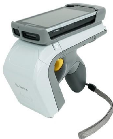
FIGURA 12. ESCÁNER DE MANO RFD8500I DE ZEBRA.
