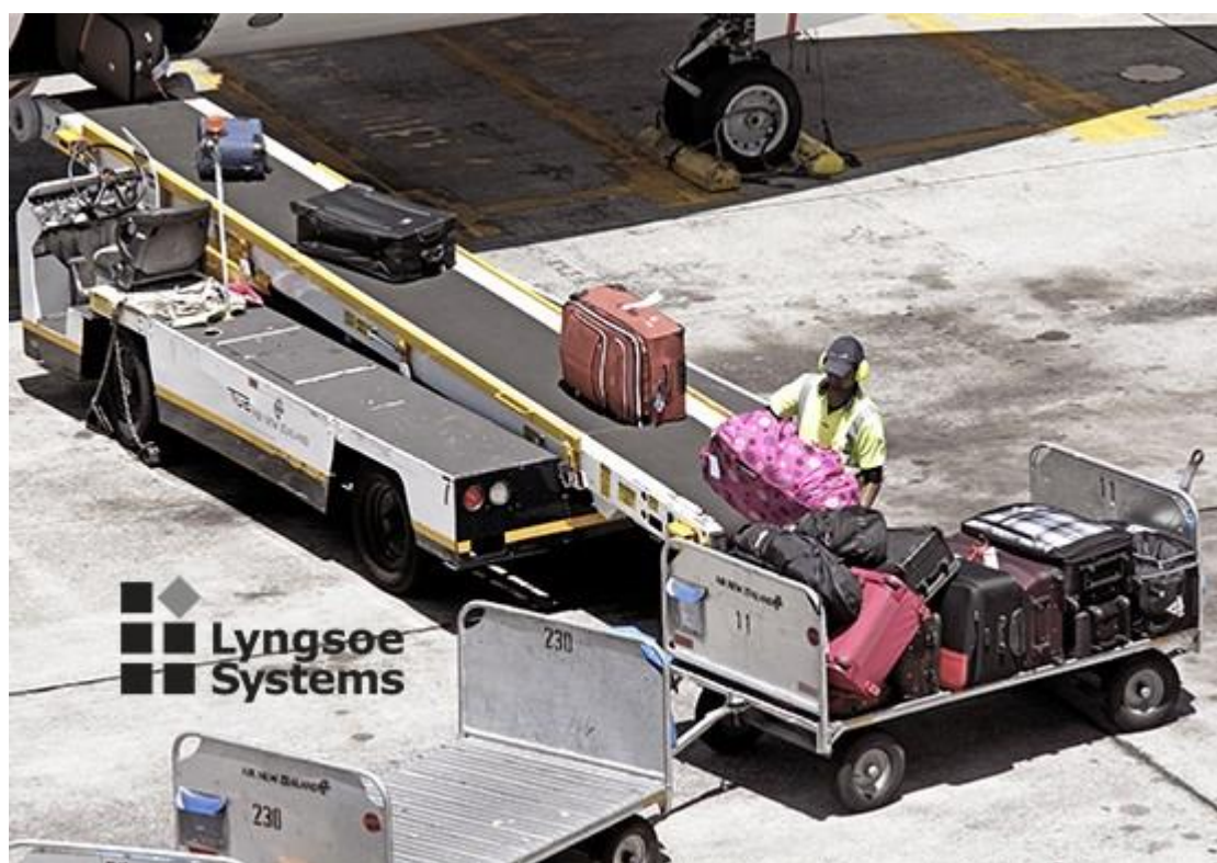
FIGURA 11. BAGGAGE BELT LOADER EN FUNCIONAMIENTO (IMAGEN DE LYGSOE SYSTEMS).
