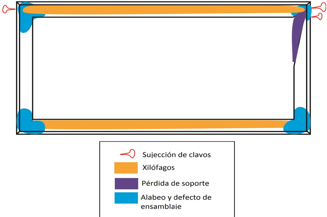
Fig.58: Croquis de daños del reverso del marco.
