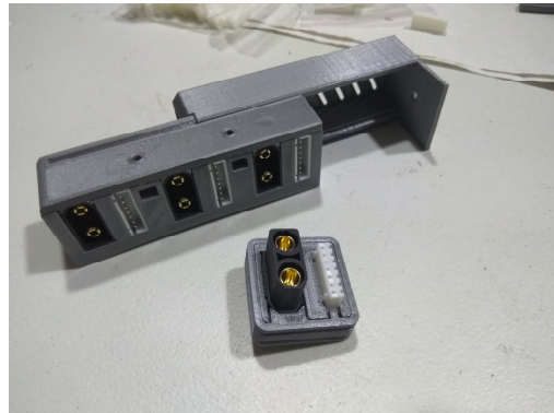
Figura 63. Enchufe y puerto de conexión.
