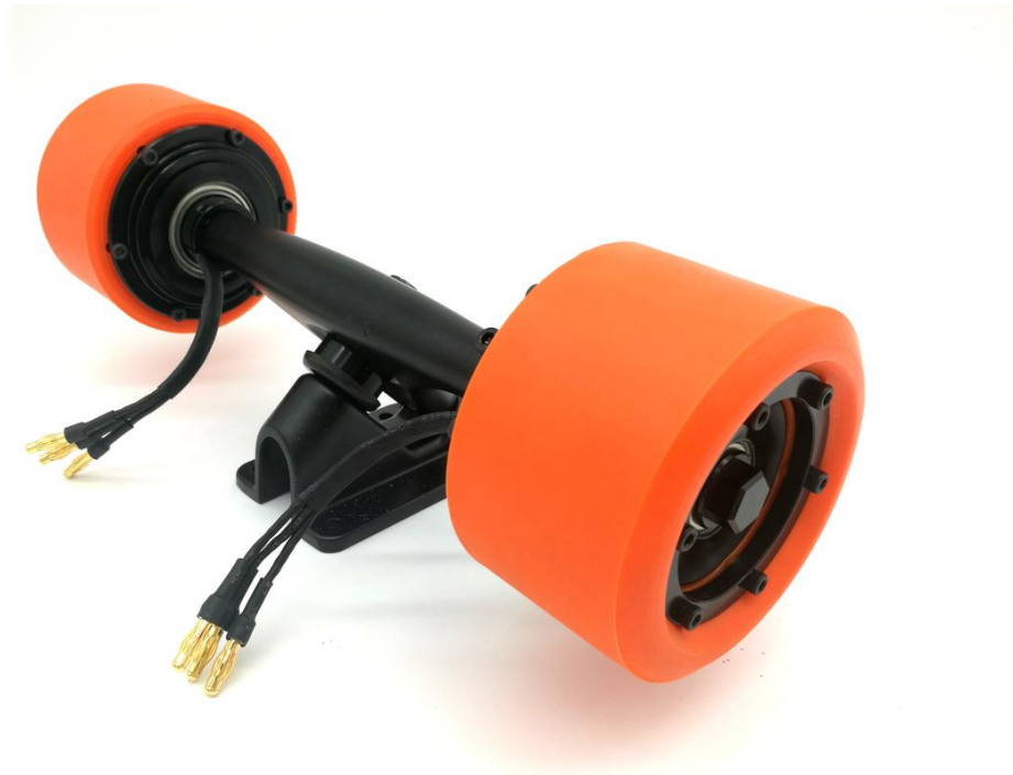
Figura 88. Truck con las ruedas de motor integrado instaladas.
