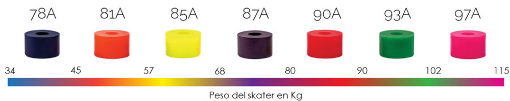
Figura 9. Dureza del bushing acorde al peso del skater.
