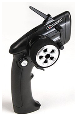
Figura 25. Emisora de 3 canales a 2.4GHz.
