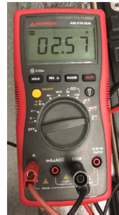
Figura 117. Corriente de vacío medida en el amperímetro (modo medium).
