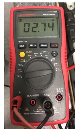
Figura 115. Corriente de vacío medida en el amperímetro (modo low).
