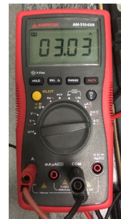
Figura 119. Corriente de vacío medida en el amperímetro (modo high).
