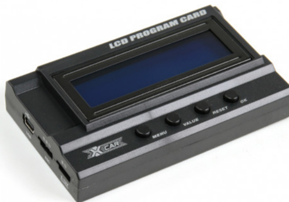
Figura 67. Tarjeta de programación para variadores X-Car.
