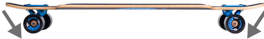
Figura 10. Posición correcta de los trucks.
