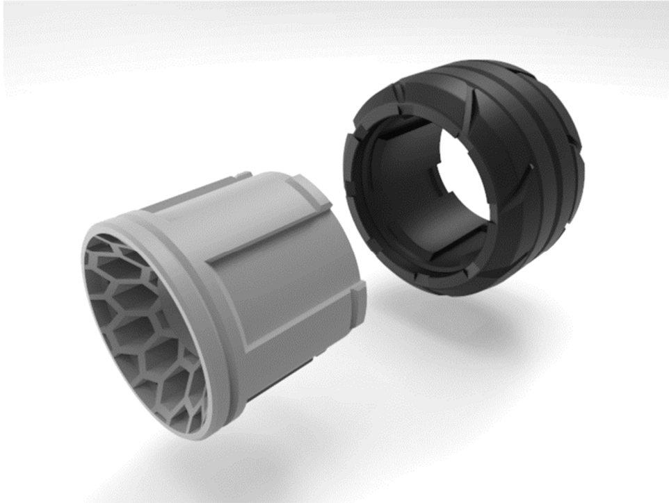
Figura 94. Rueda 3D modelo 2 – Llanta y neumático.
