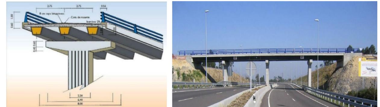
Figura 45 Puente sobre la autovía del Cantábrico. Izquierda, esquema estructural; derecha, puente [11]
