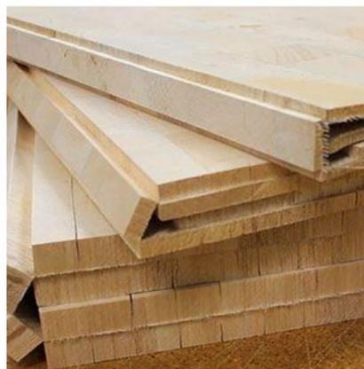
Figura 24 Madera de balsa empleada como núcleo [31]
