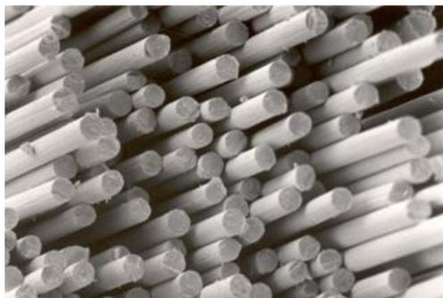
Figura 3 Filamentos de fibras de carbono [28]
