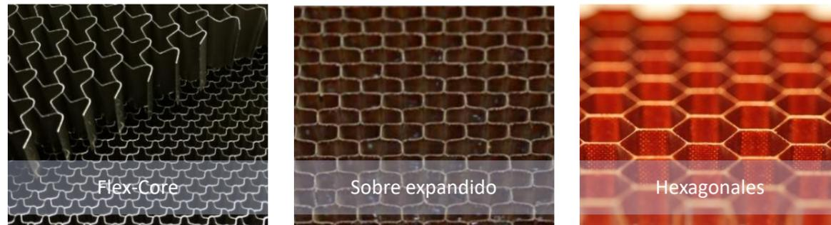
En cuanto al material empleado, se distingue dos grupos: metálicos y no metálicos. En los primeros, se suele emplear aluminio, acero, titanio y aleaciones de alta resistencia. Los núcleos fabricados suelen estar fabricados en “papel” de aramida (Núcleo Nomex), vidrio, etc impregnados con resina fenólica.
