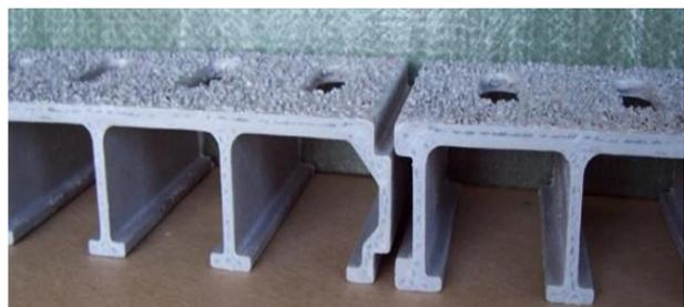
Figura 5 Uniones tipo de tableros de material compuesto [23]
