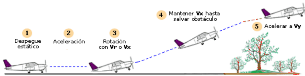
Figura 4.24: Representación de las distintas fases del despegue de una aeronave
