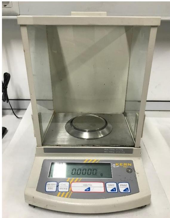
FIGURA 20. Balanza de precisión de 4 decimales.
