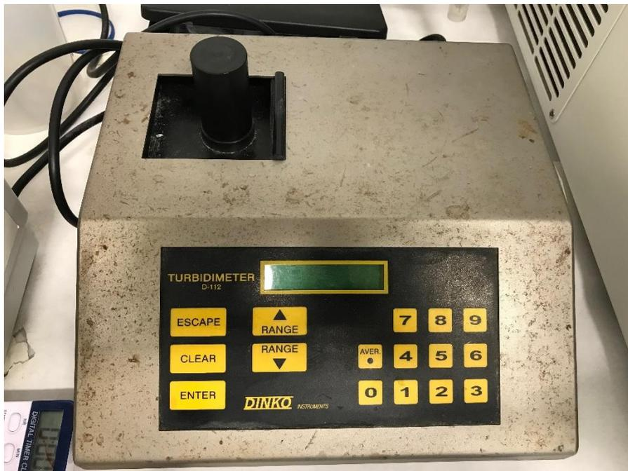
**FIGURA 22.** Turbidímetro nefelométrico. Modelo D-112, Dinko.
