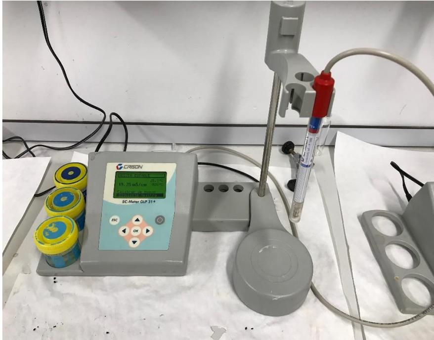
FIGURA 19. Medidor de conductividad de sobremesa. Modelo GLP 31, Crison.
