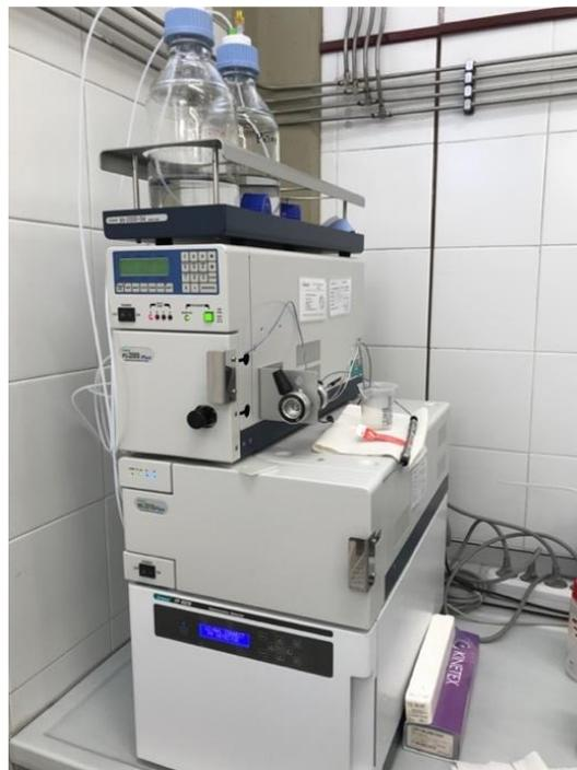
**FIGURA 15.** Equipo HPLC empleado para los análisis de agua con fármaco.
