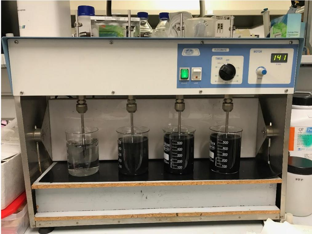
**FIGURA 25.** Floculador digital realizando un Jar-Test en agua con medicamento y carbón activado en polvo.
