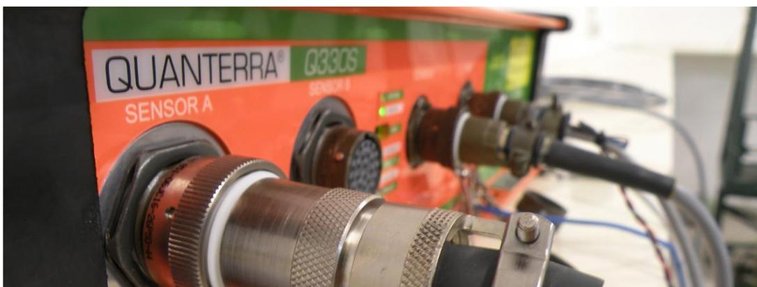
*Figura 2. Actual sismógrafo del instituto: Quanterra modelo Q330S (IGSV, 2016).*
