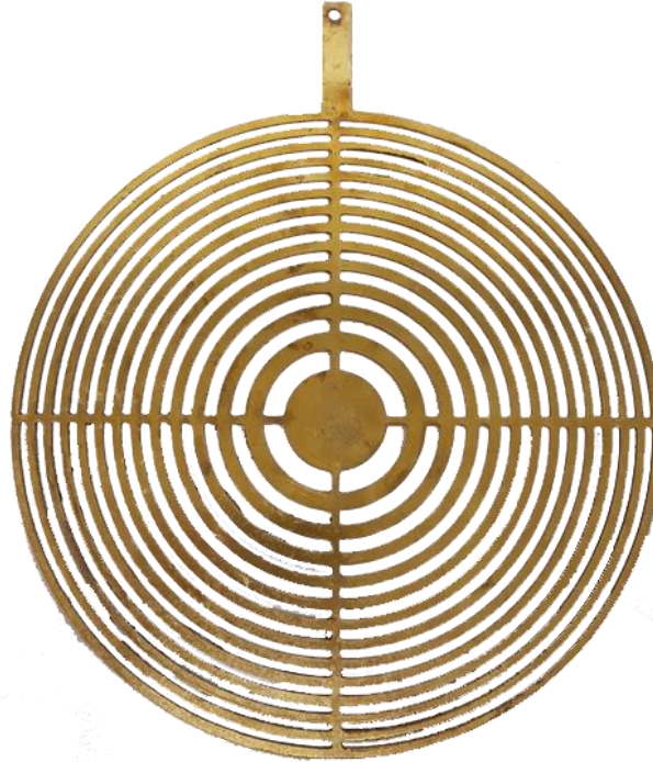
Figura 3. Lente Fresnel utilizada en los experimentos del proyecto
