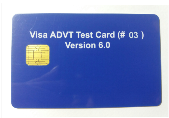
Figura 4.1: Detalle del anverso de una de las tarjetas de certificación VISA utilizadas. Sin soporte contactless .
