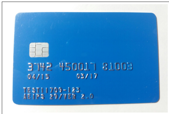
Figura 4.5: Detalle del anverso de una de las tarjetas de certificación AMEX utilizadas. Sin soporte contactless .
