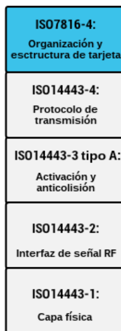
Figura 3.10: Detalle de la pila de protocolos en HCE
