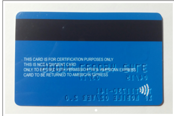
Figura 4.4: Detalle del reverso de una de las tarjetas de certificación AMEX utilizadas. Con soporte contactless .
