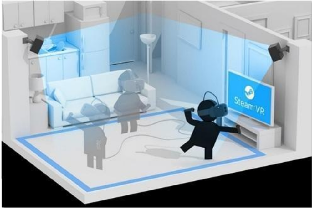
Figura 3: Funcionamiento sensores de movimiento de las HTC Vive
