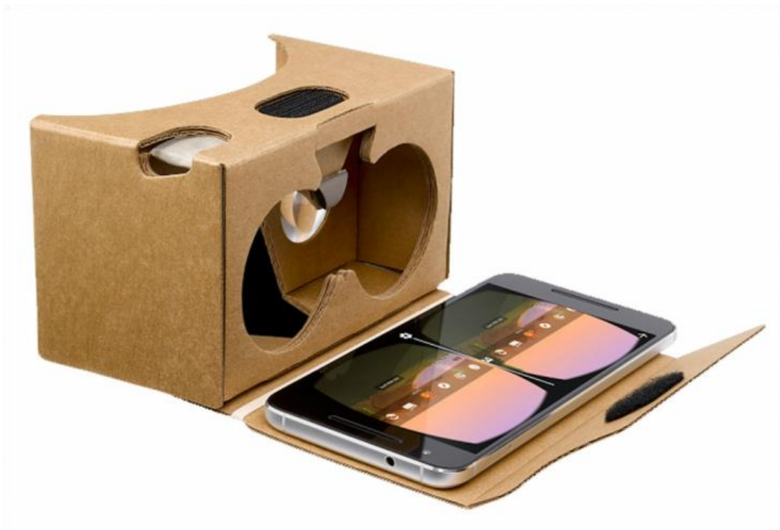
Figura 41: Solución de las Google CardBoard a la sujeción del Móvil
