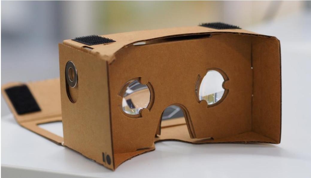
Figura 9: Imagen trasera de las Google CardBoard montadas, con su botón-imán y placa de lentes
