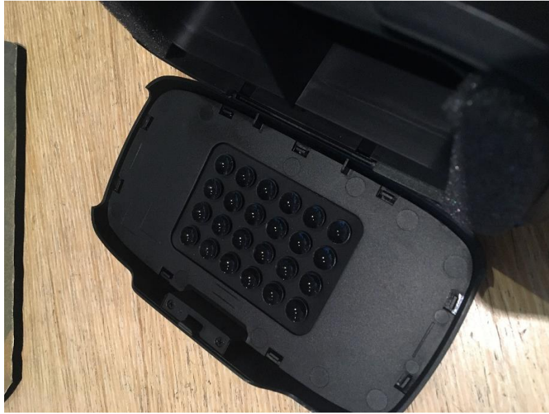
Figura 40: Solución de las Aukey VR Cardboard a la sujeción del móvil
