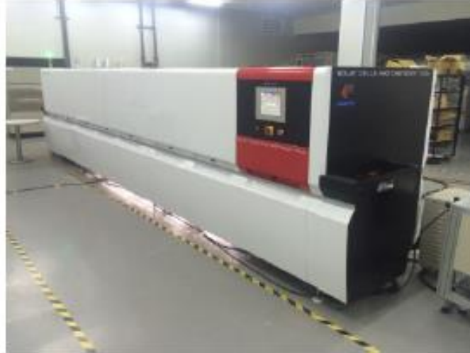
Figura 5 - 1 Foto del equipo de hidrogenización avanzada de la empresa Asia Neotech basado en iluminación LED. Fuente: (Hallam, et al., 2017)
