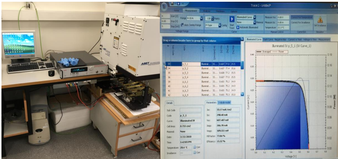
Figura 3 - 6 Estación del Simulador Solar(izq) e interfaz (der) del programa Tracer 2, para la caracterización I-V de células solares
