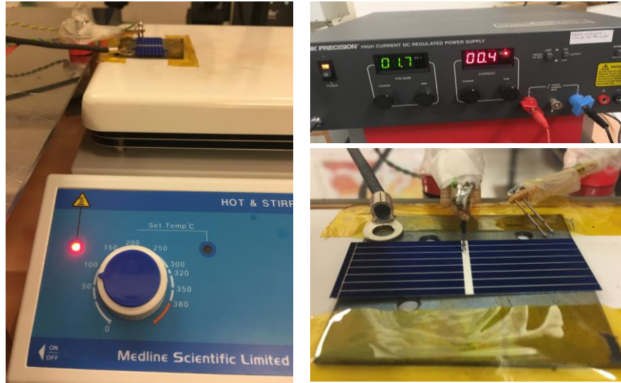
Figura 3 - 18 Imágenes del test de corriente en células Fuente Propia
