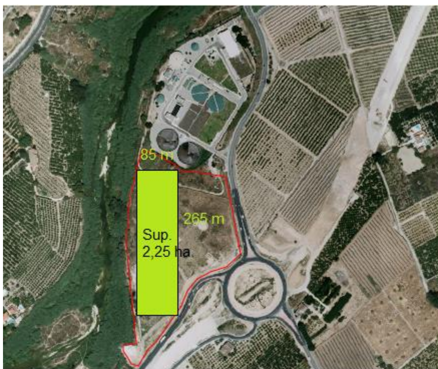
Figura 3.2 Disposición final del humedal artificial (Elaboración propia).
