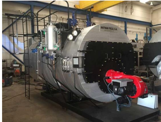
Ilustraci3n 19: Caldera de vapor.
