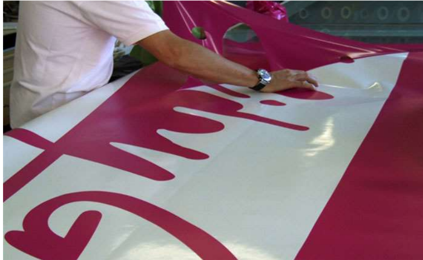
FIGURA 3.6: Vinilo troquelado o cortado
