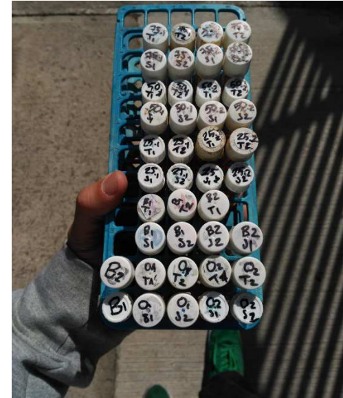
Fotografía 10, Sello para los septum de goma que tapan los digestores.
