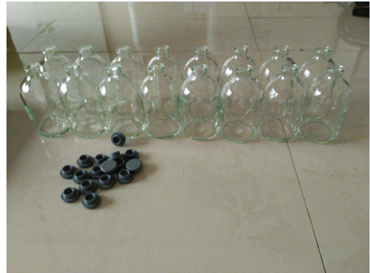
Fotografía 2, Digestores discontinuos que Angelidaki et al, (2009) utilizan, junto con el septum que lo cierra.
