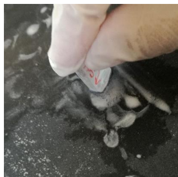
Figura 30: Lijado de la muestra con una lija de agua de gramaje 400
