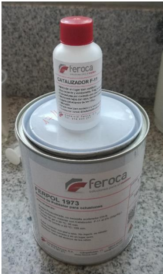
Figura 24: Resina Ferpol 1973 y su catalizador F11
