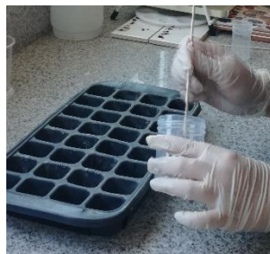
Figura 27: Englobado de las muestras mediante palo de hisopo por goteo
