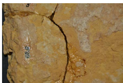
Fig. 23: Reverso del azulejo C-AZ-7 donde se aprecia la disgregación por cristalización de sales, adhesión incorrecta, restos de mortero y de adhesivo.
