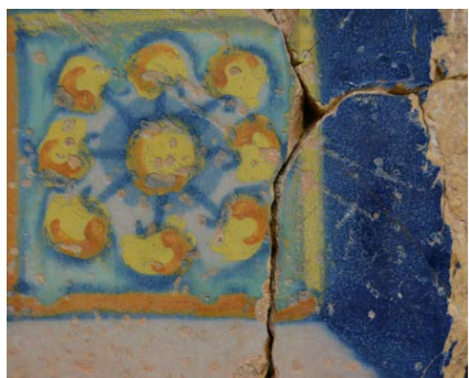
Fig. 27: Anverso del azulejo C-AZ-7 donde se aprecian rallados en la película vítrea de origen antropológico.
