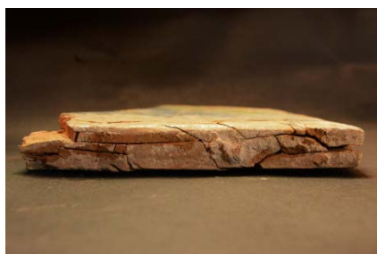
Fig. 24: Disyunción en lasjas de la pasta cerámica del azulejo C-AZ-9.
