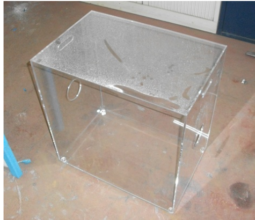
Figura 37. Cajón de polietileno transparente para el ensayo de los defectos sin tierra.
