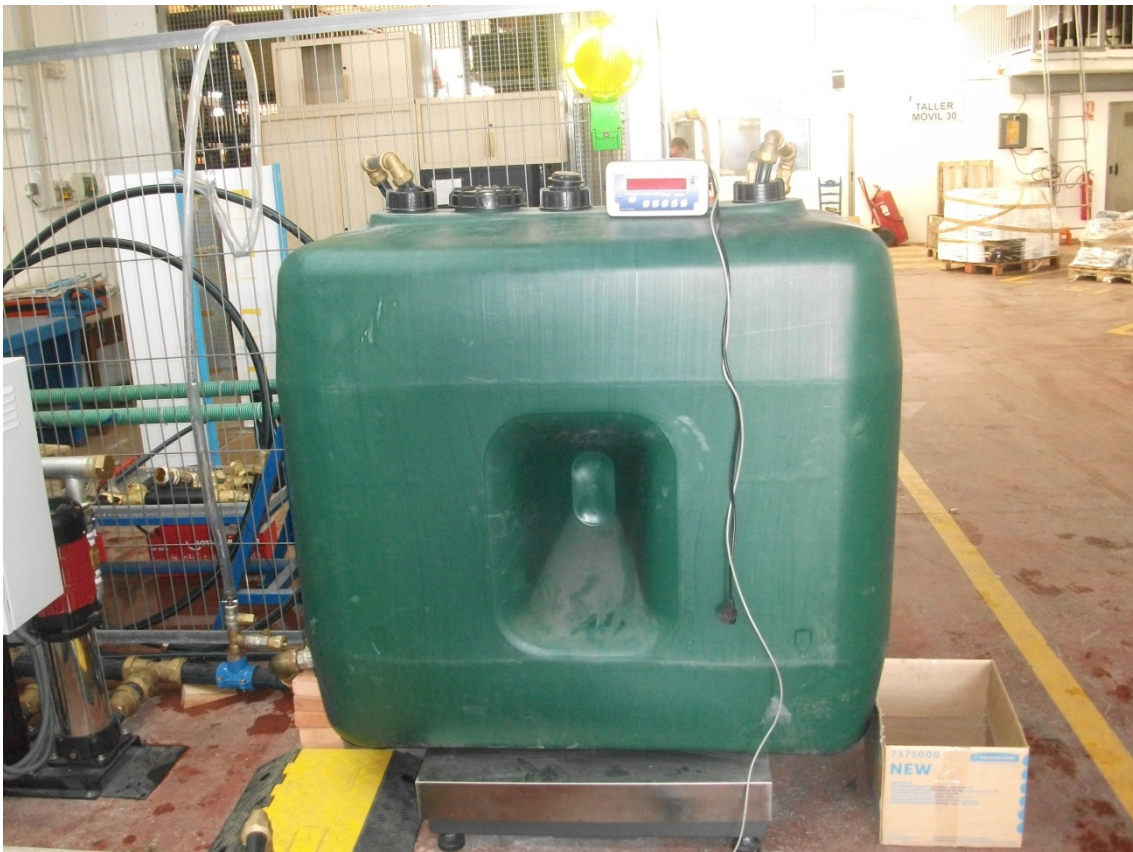
Figura 25. Depósito de reserva no presurizado usado en el banco de ensayos.
