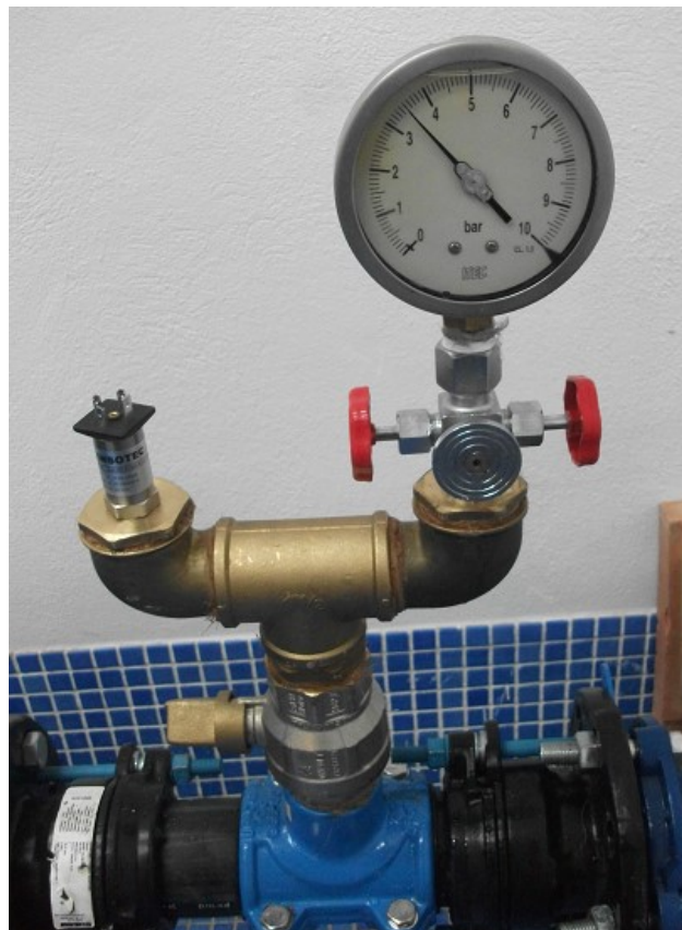
Figura 34. Sensores de presión instalados en el banco de pruebas.
