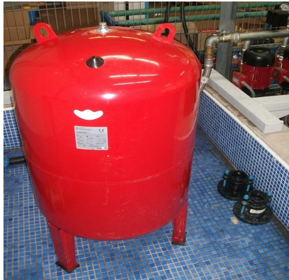
Figura 29. Calderín usado en el banco de pruebas.
