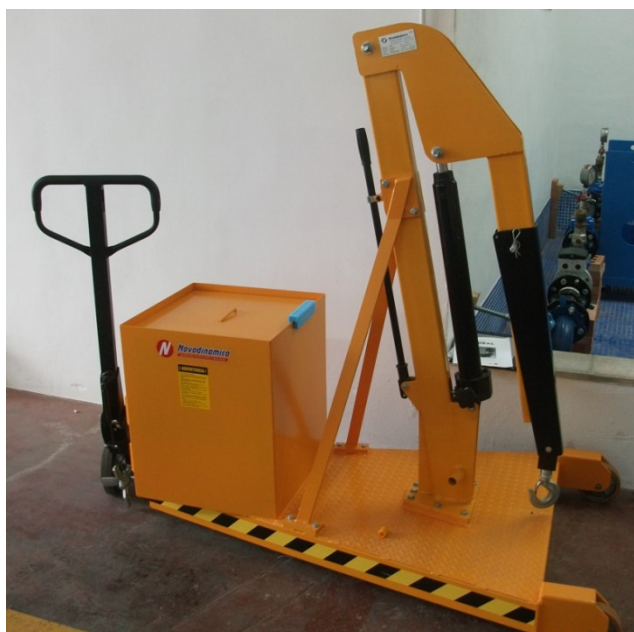
Figura 44. Grúa contrapesada manual comprada para el banco de fugas.
