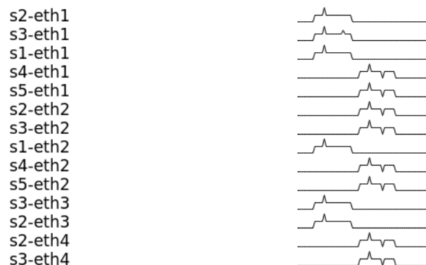
Figura 30. Interfaces de los conmutadores de la red SDN con dos caminos, y el tráfico detectado en ellas durante las pruebas de Iperf.
