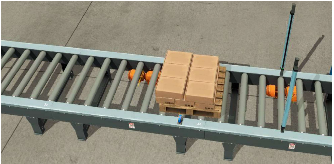
Ilustración 44. Palé de dos pisos pasando por el sensor “flow”. Fuente: Elaboración propia.
