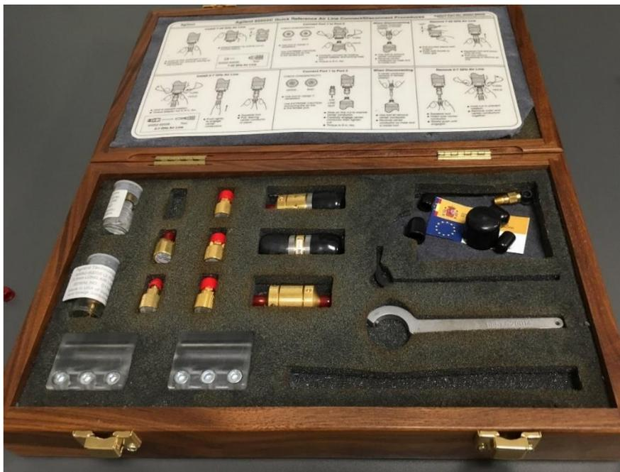
Figura 5.11. Kit de calibración del VNA
