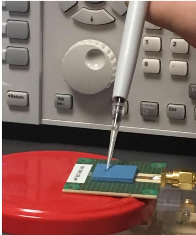
Figura 5.28. Colocación del material en cavidad del sensor
