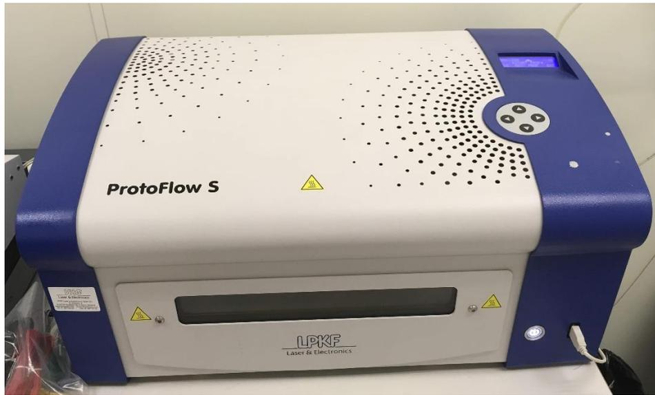
**Figura 5.4. Horno de ensamblado de PCB**
