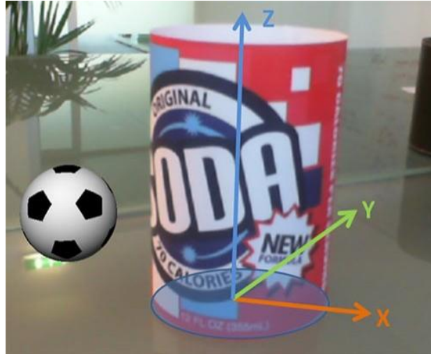
Ilustración 3. Ejemplo de reconocimiento de un Cilinder Target
