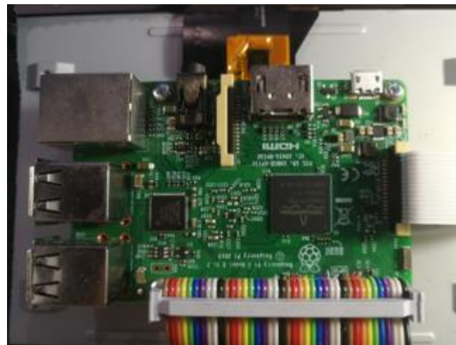
Figura 2.11. Raspberry pi conectada a pantalla TFT.
