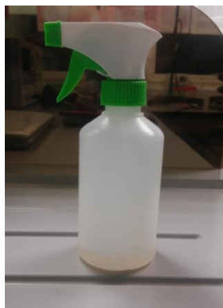
Figura 11. Pulverizador con el que se aplican los recubrimientos.
