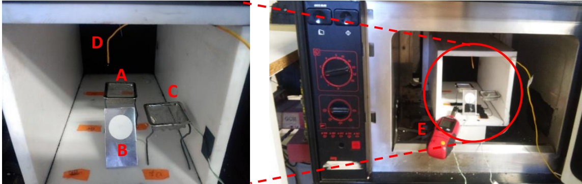
Figura 13. Montaje experimental en el interior del túnel de flujo de aire caliente. A: Cesta con cápsulas para medir la variación de masa en el tiempo, B: Pegatina con emisividad conocida y termopar tipo K acoplado, C: Cesta con cápsulas y termopar tipo K para medir la variación de temperatura del lecho en el tiempo, D: Termopar tipo K que mide la variación de temperatura en el interior de la cámara, E: Higrómetro que mide la humedad en el interior de la cámara.
