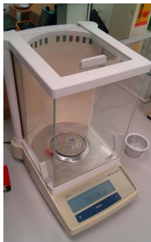
Figura 15. Balanza de precisión usada para medir la masa de las muestras.
