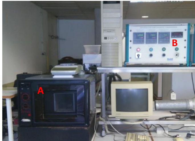
Figura 9. A) Cámara de secado; B) Controlador de la temperatura en el secadero.
