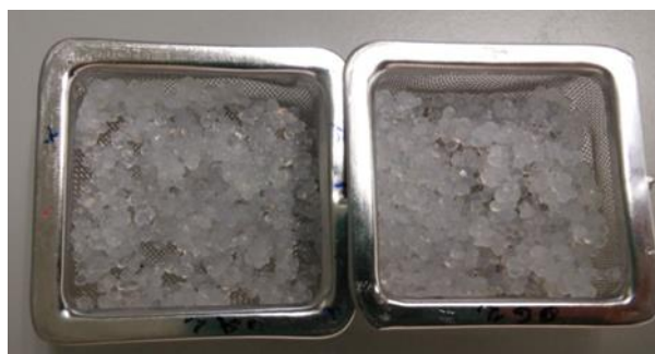
Figura 8. Cápsulas de alginato de calcio húmedas colocadas en las bandejas de secado antes de introducirse en el secadero.
