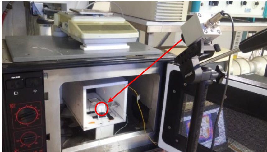
Figura 18. Montaje de la cámara termográfica Optris PI® 160 (Optris GmbH, Berlin, Alemania).
