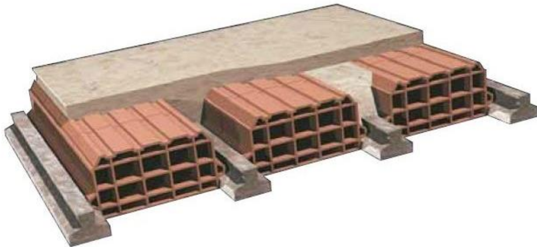
Figura 7- Forjado de viguetas y bovedillas.
