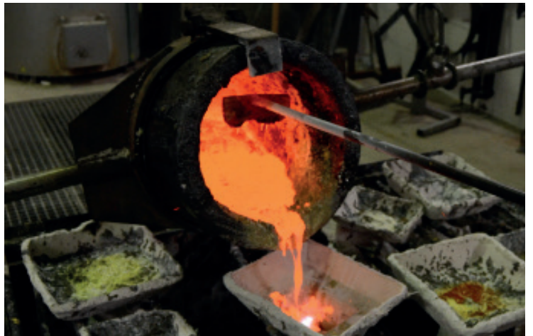
Fig. 45. Proceso de construcción. Colada de fundición.
