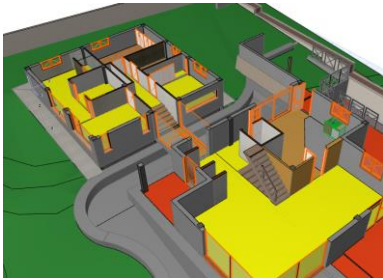
Figura 56. Modelado de las particiones. LOD 100. Fuente propia. Archicad 20. 2018
