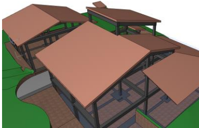
Figura 47. Modelado de la cubierta. LOD 100. Fuente propia Archicad 20. 2018
