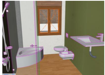
Figura 65. Modelado de sanitarios. LOD 300. Fuente propia. Archicad 20. 2018
