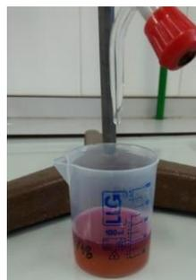
**Imagen 30:** Valoración muestra con NaOH.
