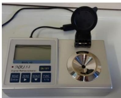
**Figura 26:** Refractómetro para llevar a cabo las medidas de índice de refracción.
