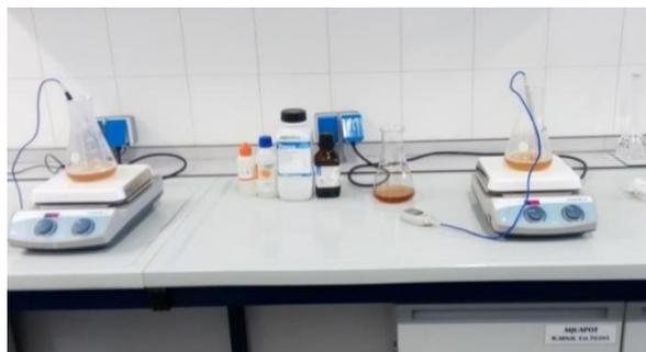
**Figura 28:** Dos muestras durante el proceso de descarbonatación.
