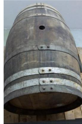
**Figura 15:** Barrica para llevar a cabo el control y seguimiento de un proceso de acetificación de cerveza.
