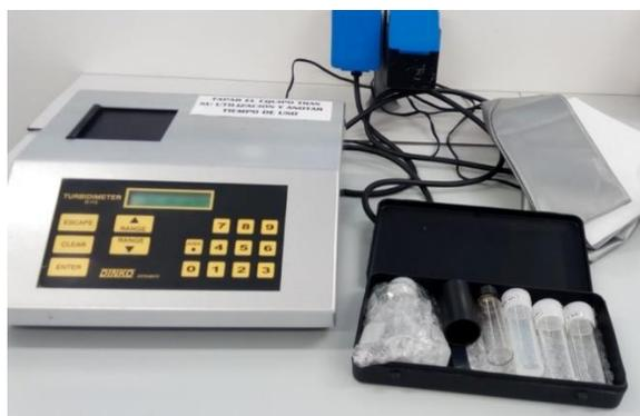
**Figura 27:** Turbidímetro y patrones de calibrado, empleados en el presente TFM.
