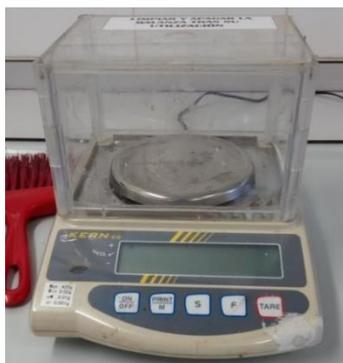
**Figura 24:** Balanza para realizar pesadas para la preparación de disoluciones.
