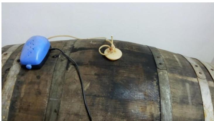
**Figura 20:** Colocación de aireador y difusor de aire en la barrica.
