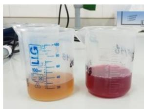
**Figura 31:** Muestra sin valorar y muestra valorada que ya ha alcanzado punto de viraje.
