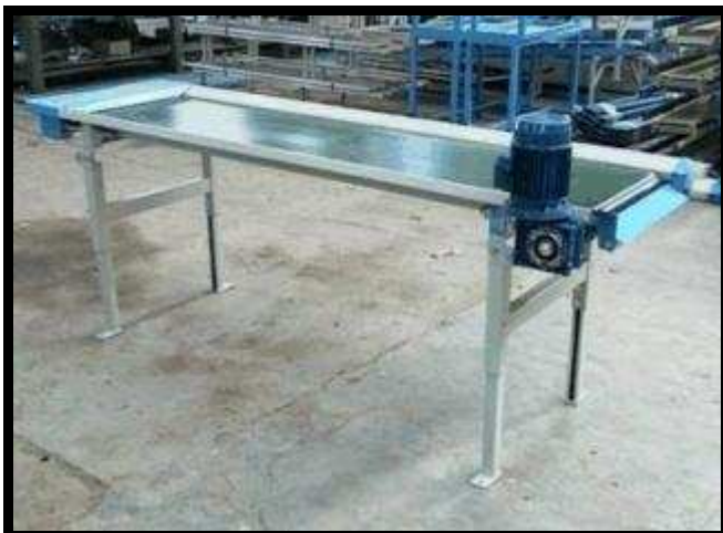
Figura 37: Transporte salida cajas llenas
