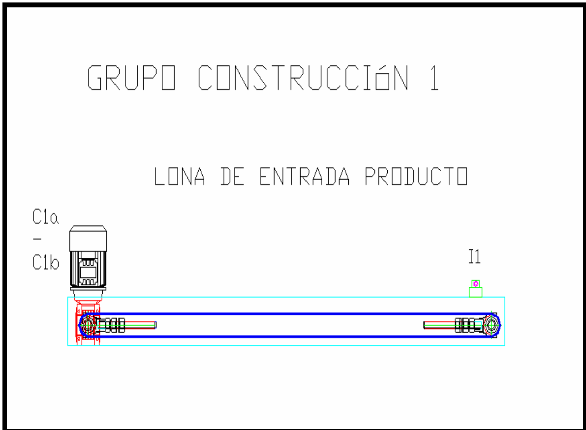
Figura 29: Plano estructura de lona entrada
