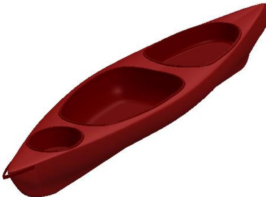
*Figura 25. Vista isométrica de kayak diseñado. Fuente: Propia.*
