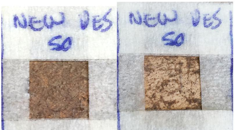
Fig. 23. Prueba de limpieza con NewDes 50.
