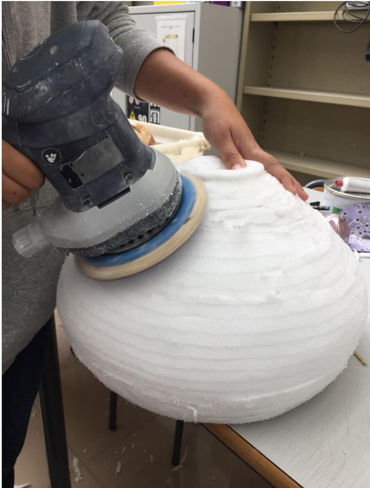
*Fig. 8. Lijado del soporte.*
