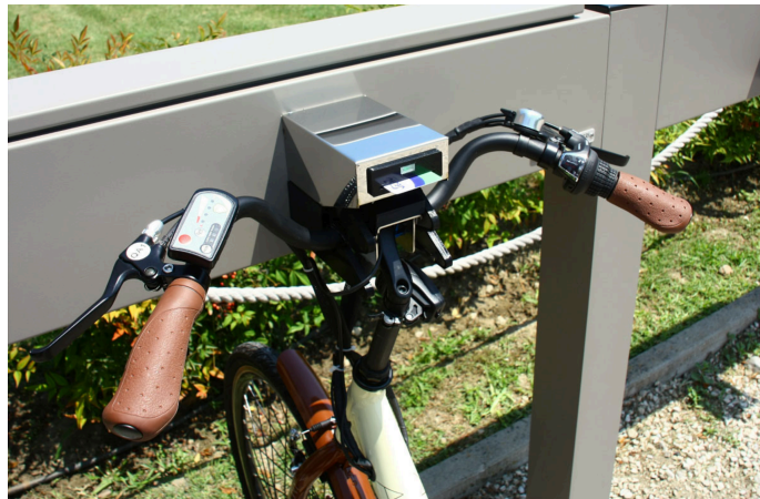
Figura 18 Uso de tarjeta inteligente RFID en sistema de bicicleta compartida
