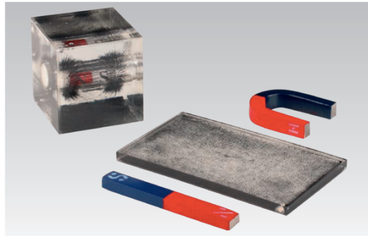
Figura 39. Limaduras de hierro en torno a un imán [36].
