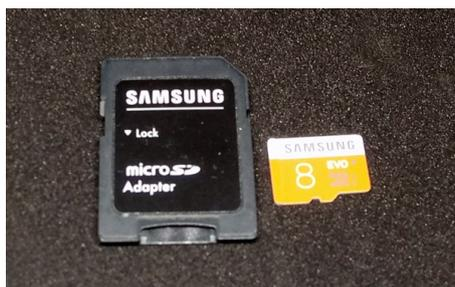
Figura 6.2: Tarjeta Micro-SD con adaptador.
