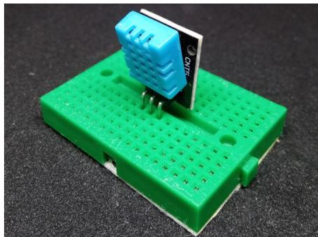
Figura 4.3: Sensor DHT11 de temperatura y humedad.
