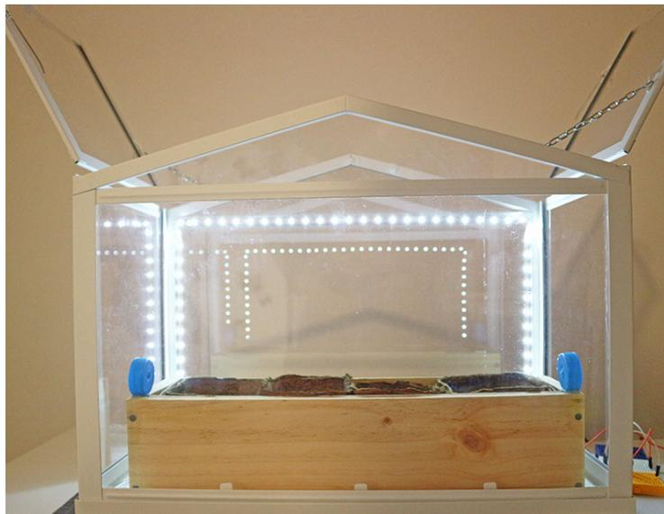
Figura 6.13: Iluminación LED instalada en invernadero.
