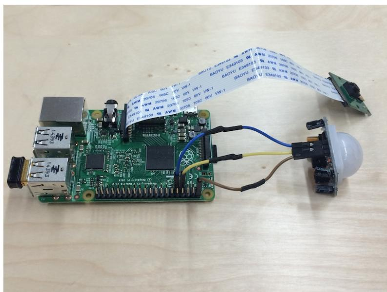
Figura 2.5: Raspberry Pi con cámara y sensor de presencia conectados.
