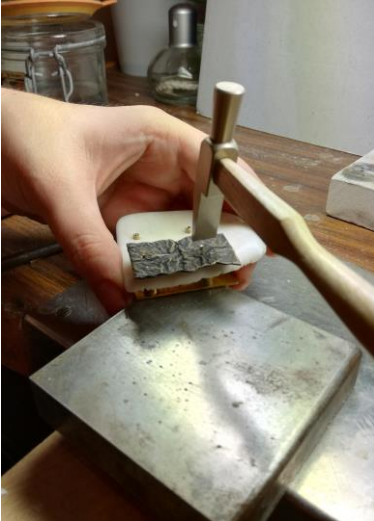
Fig. 15: Proceso de remachado.
