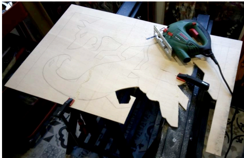
Fig.44 Proceso de corte de las capas de madera
