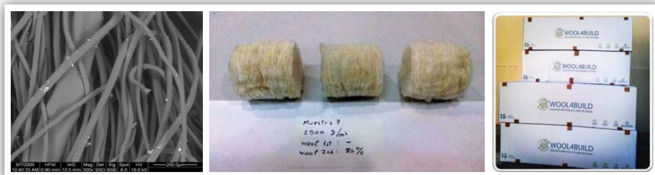
Figura 1. Muestras del material absorbente de lana de oveja. Composición a nivel microscópico (izquierda), muestras preparadas para test acústicos (centro) y muestras embaladas preparadas para comercialización (derecha).
